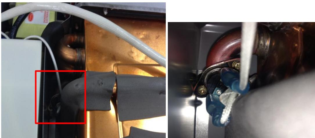
Detalhe: O sensor passa a ser localizado na parte traseira esquerda da câmara, conforme a imagem acima.
